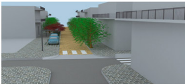
Εικόνα 6: Βιοκλιματική ανάπλαση της οδού Πλούτωνος με διαπλάτυνση πεζοδρομίων, διαμόρφωση διαβάσεων και ειδικές εσοχές για τη στάθμευση των οχημάτων διακοπτόμενες από φύτευση.
