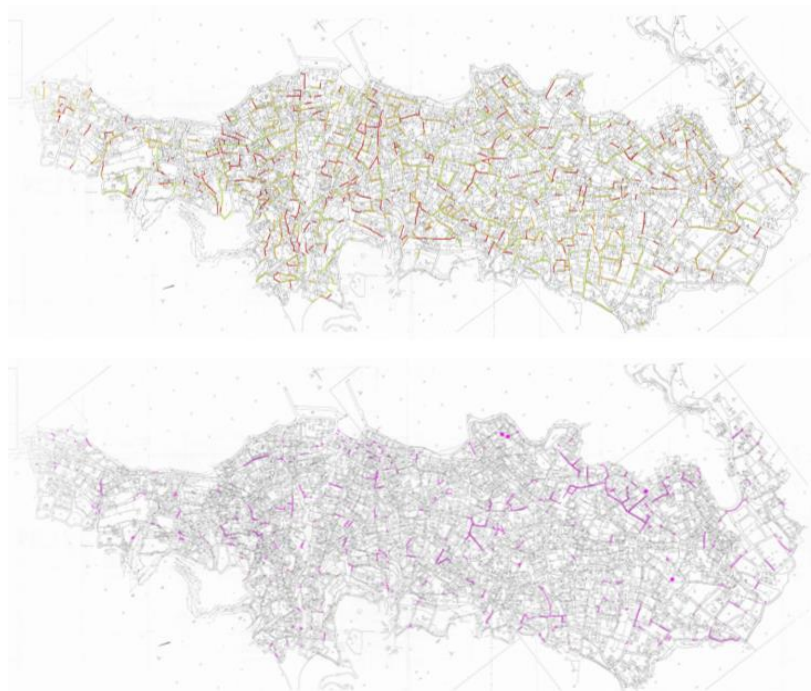
Εικόνες 4.6.1.α & 4.6.1.β Κατηγοριοποίηση οδικών αξόνων, βάσει του υφιστάμενου πλάτους οδικού δικτύου. Με κόκκινο χρώμα διακρίνονται οι οδοί με πλάτος οδοστρώματος μικρότερο των 3 μ., ενώ με ροζ χρώμα αποτυπώνονται τα αδιέξοδα.
