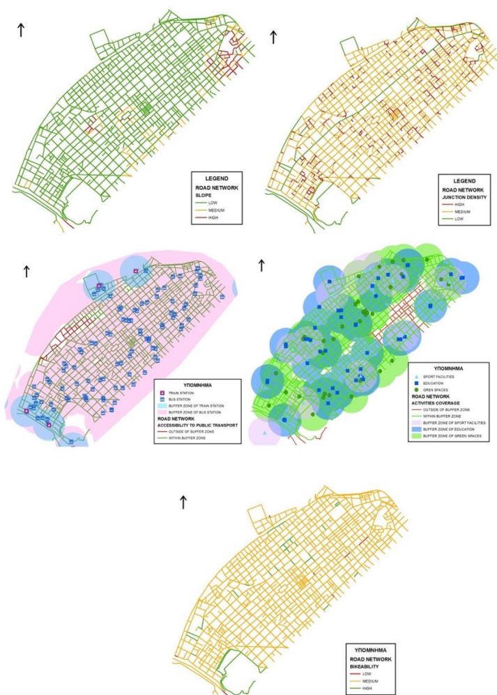
Εικόνα 4.7.4. α-ε: Μελέτη οδικού δικτύου Καλλιθέας ως προς τις κλίσεις του εδάφους, της πυκνότητας των διασταυρώσεων, χωρική ανάλυση των δραστηριοτήτων και της προσπελασιμότητας της δημόσιας συγκοινωνίας. Χαρτογραφική απεικόνιση bikeability
